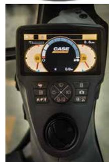
Модели серии С оснащаются **двигателями Isuzu**, повышающими рабочие показатели машины и оптимизирующими расход топлива. Оператор может отслеживать расход топлива с помощью **новой функции индикации экономичности работы — ECO-функции**, которая в режиме реального времени показывает уровень экономии топлива.
